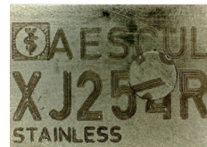
ボックスロック部の ネジにすれ
