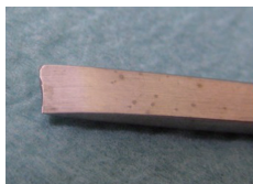
刃の摩耗や損傷の例
