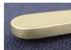
貼合せ部の腐食
