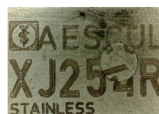
ボックスロック部の ネジにずれ
