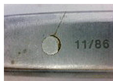
ネジ部の亀裂 (応力腐食割れ)
