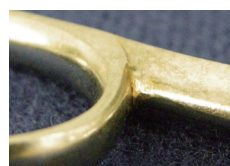
リング部とシャフト部の 亀裂
