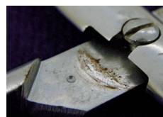
ヒンジ部の擦過腐食 (潤滑不足)
