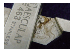
ヒンジ部の擦過腐食 (潤滑不足)
