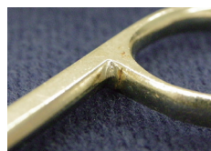
リング部とシャフト部の 亀裂
